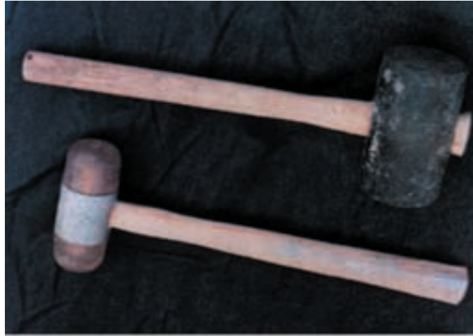
شکل ۶-۹- تخماق لاستیکی یا چکش لاستیکی
