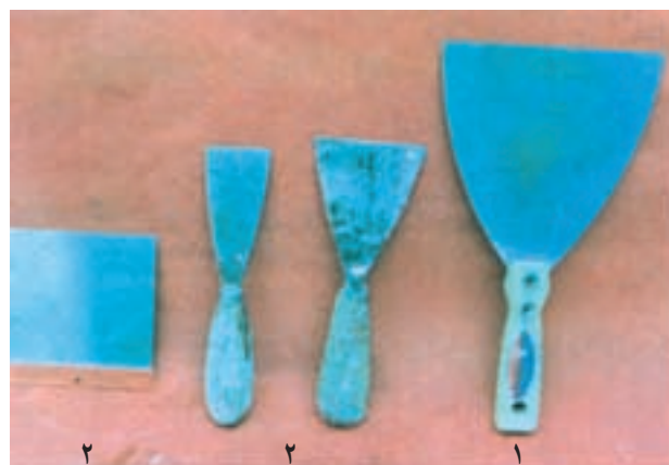
۱- کاردک میانی برای تمیز کردن ابزار ۲- کاردک کناری برای دوغاب‌ریزی موزاییک فرش و بتونه
