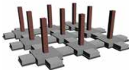
شکل ۲-۱۸- پی کلاف شده
