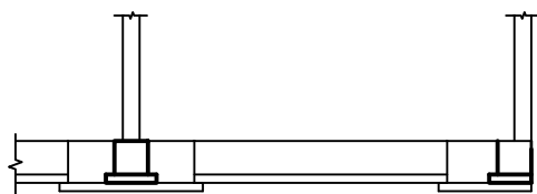
شکل ۵۱-۱ برش (پی و شناژ دارای ارتفاع های متفاوت اند).
