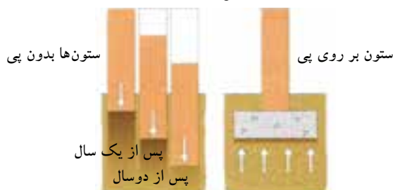
شکل ۱-۲۹ تاثیر بار بر روی پی و زمین
