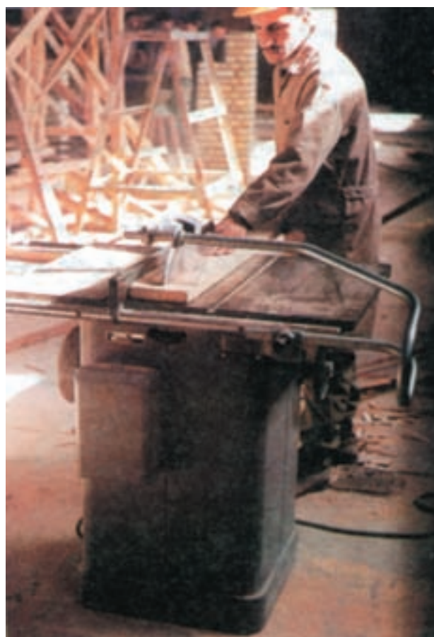
شکل ۶۴-۱- روش بریدن طولی تخته با ارّه‌ی گرد برقی میزی
