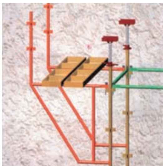
شکل ۷-۴۵ - سکوی کار برای داربست فلزی
