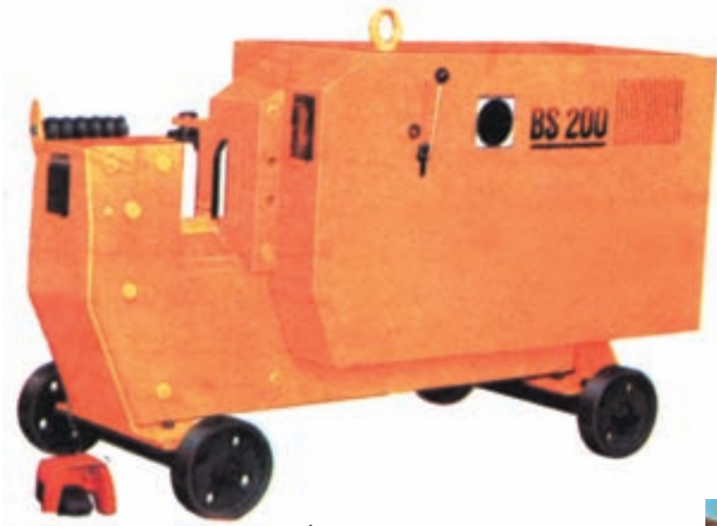
شکل ۵۶-۲- یک نمونه ماشین برقی برش میل‌گرد
