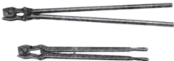
شکل ۵۳-۲- قیچی‌های دستی ساده برای برش میل‌گرد فولادی
