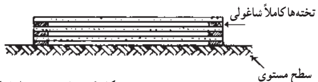
شکل ۶-۱۰- نحوه‌ی انبار کردن صحیح تیرچه‌ها
