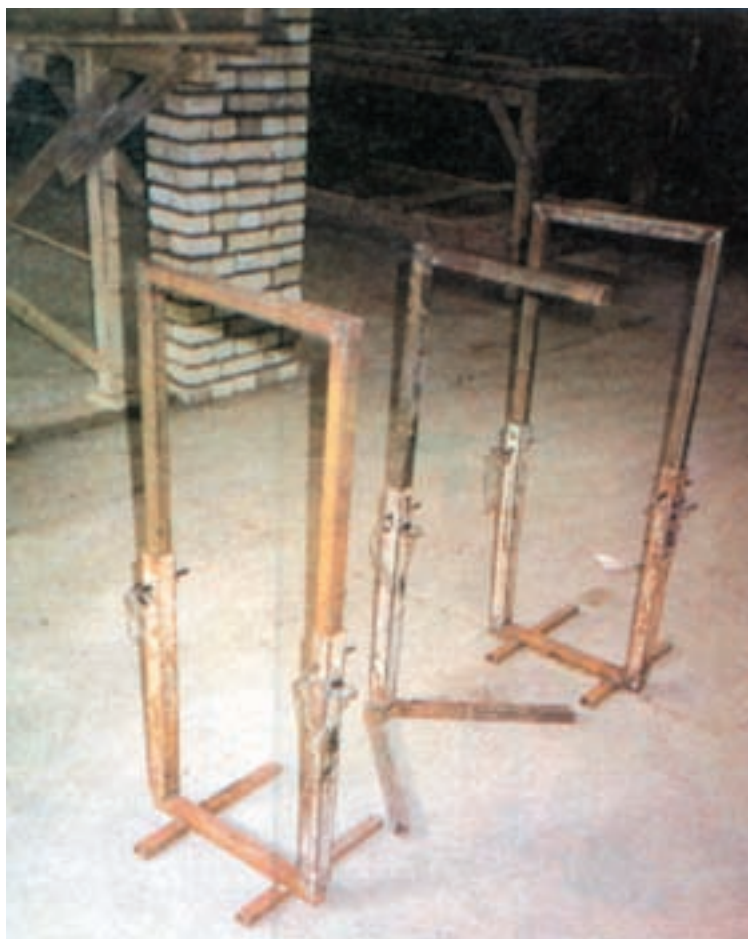
شکل ۹۴-۲- خرک های فلزی برای مونتاژ میل گرد
