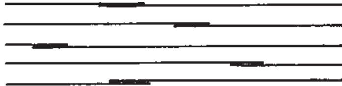
شکل ۴۰-۲- محل های اتصال میل گردها تا آنجا که ممکن است پراکنده باشند.
