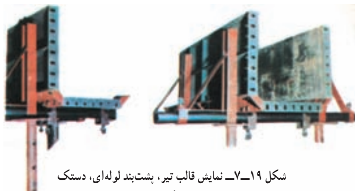
شکل ۷-۱۸- نمایش دستک تیر بر روی پشت‌بند لوله‌ای
