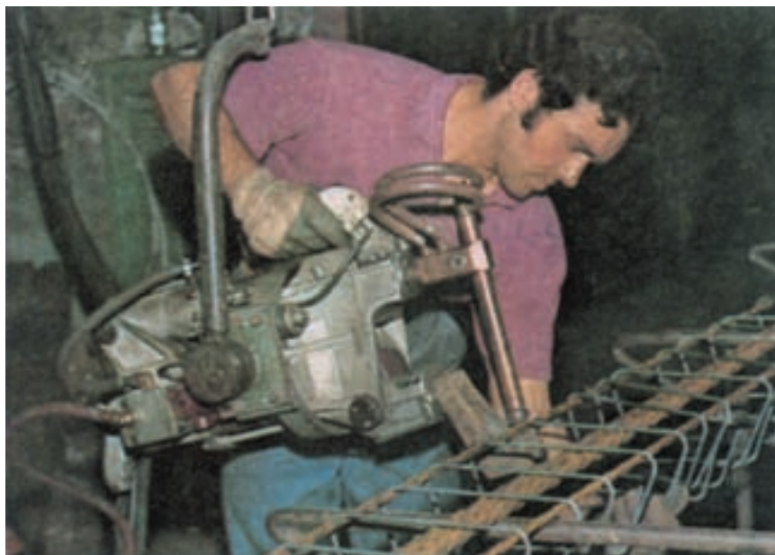
شکل ۲-۲۷- دستگاه نقطه جوش برای اتصال میل‌گردها به یکدیگر
