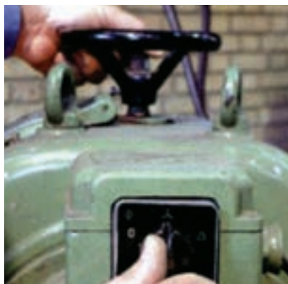
شکل ۷-۲۱- قرار دادن کلید دینام جوشکاری
