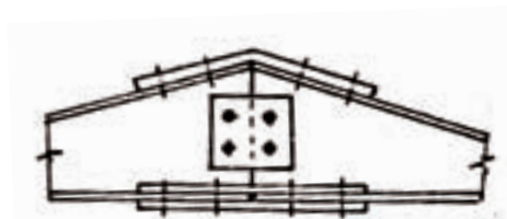
شکل ۱۰-۲۹- اتصال با ورق روسری
