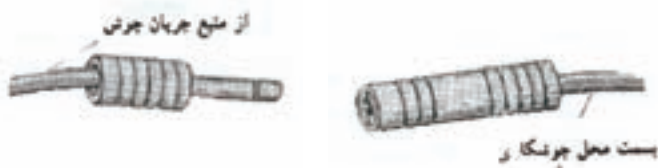
شکل ۲۹-۷- نمونه اتصال کابل‌ها به یکدیگر
