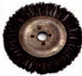
شکل ۷-۲۵- برس سیمی و تمیزکاری قطعه جوشکاری شده با آن
