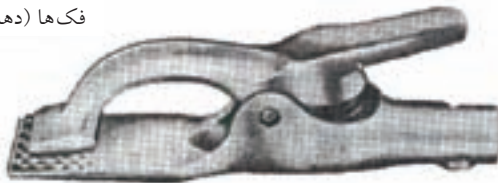
شکل ۷-۳۲- گیره اتصال به قطعه کار
