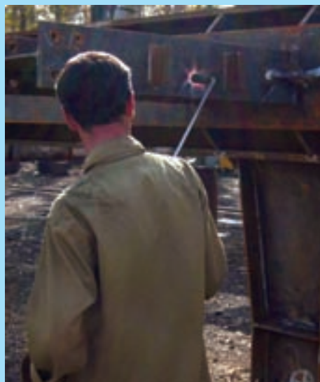
صاف کردن قطعات به کمک مارت
