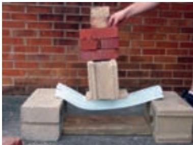
شکل ۵-۵- آزمایش فمش تیر
