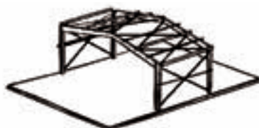
اجرای زیرسازی پوشش سقف (لاپه ریزی)
