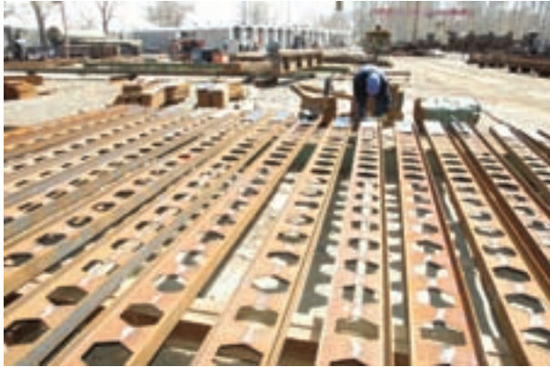
ادامه شکل ۵-۲۲- جوشکاری ممل اتصال دونیمه
