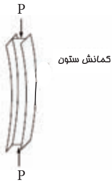
شکل ۴-۳- کمانش عضو فشاری
