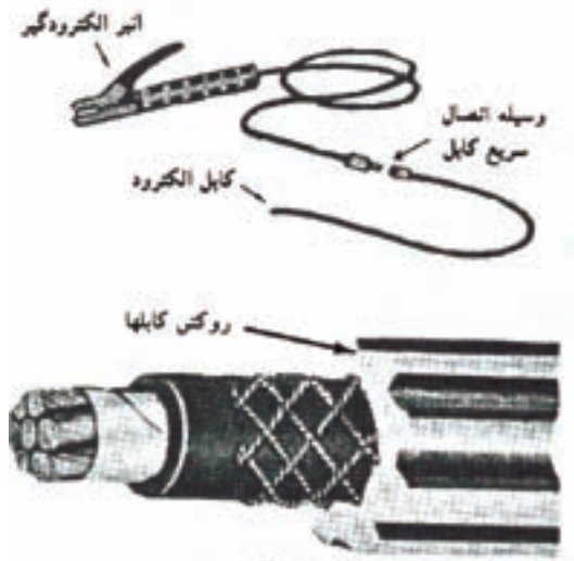
شکل ۲۷-۷ مقطع کابل جوشکاری قوسی
