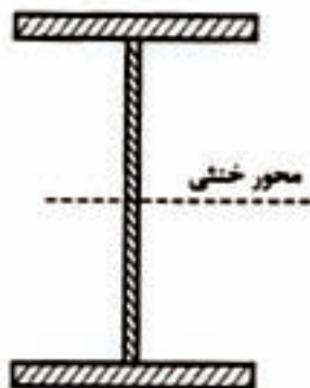
شکل ۱۱-۹- محور خنثی در تیورورق متقارن H شکل
