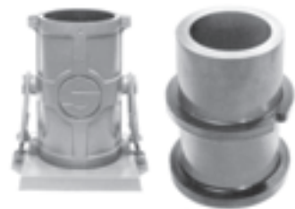
قالب نمونه‌های استوانه‌ای براساس استاندارد ASTM
