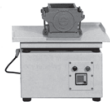
میز لرزان برای متراکم کردن نمونه‌های آزمایشی
