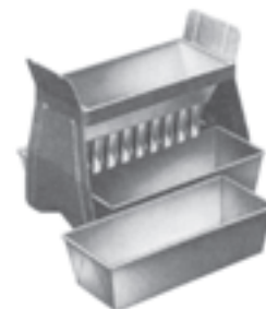
دو نوع قوطی مقسم برای تقسیم‌بندی نمونه‌های سنگ‌دانه
