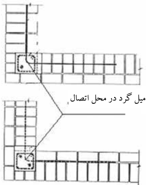
شکل ۱ - ۵۰ : رعایت اصول اتصال دو دیوار
