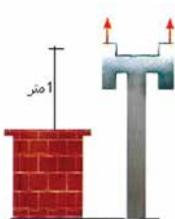
شکل ۱ - ۶۲: نصب صحیح لوله دودکش داخل اتاق
