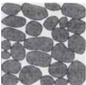
بتن خشن با دانه‌بندی درشت و متخلخل
