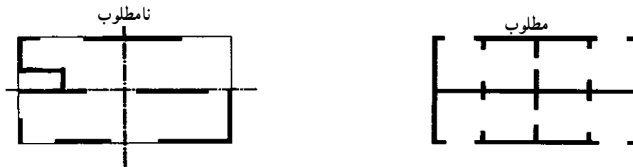
شکل ۱۰-۵ - نحوه‌ی قرارگیری دیوارها به طور منظم و متقارن در پلان ساختمان
