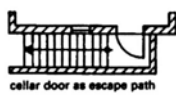
(۳) اتاق کوره با دو در (مداقل ۲۲ m 3 ) که به گرمای خروجی بیش از ۳۵۰ kW احتیاج است
