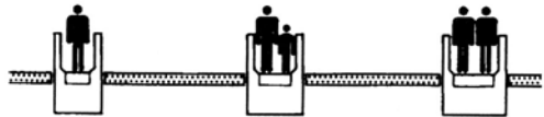
(۷) پله برقی با بهنای ۶۰ سانتی‌متر (۸) پله برقی با بهنای ۸۰ سانتی‌متر (۹) بهنای ۱ متر
