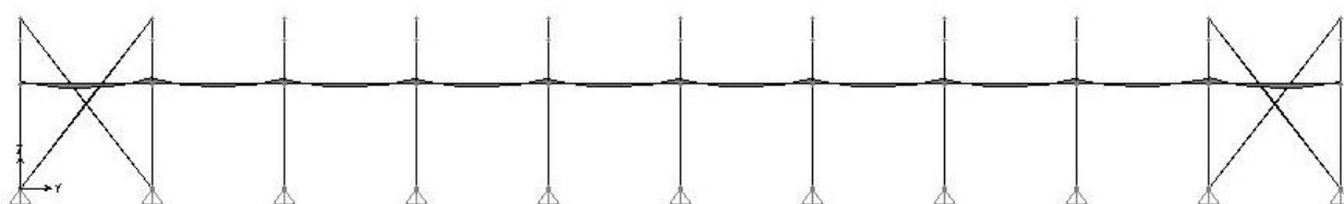
دیاگرام لنگر خمشی تیر عرضی سازه
