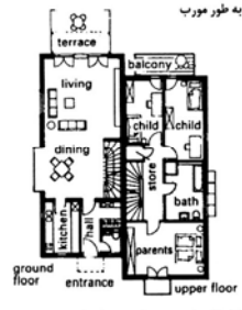
(۸) خانه‌های نیمه‌جدا ورودی از جلو
