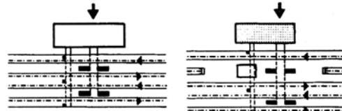
(۳) تلاقی از یک طرف، پایین‌تر از سطح خط آهن؛ تونل برای مسافران و توشه؛ دسترسی توسط پله‌ها و آسانسور به سکوها (راه حل متداول مقرون به صرفه)
