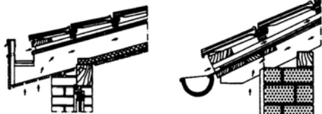
(۷) تهویه فضای سقف از داخل اتصالات نمای چوبی سقف
