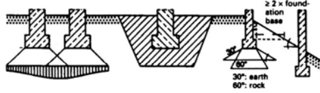
(۴) داخل تأثیر پی‌ها، باعث خطر نشست و ایجاد ترک خواهد شد (این مورد، درباره ساختمان‌های جدیدی که در کنار ساختمان‌های قدیمی احداث می‌شود، قابل اهمیت است).
