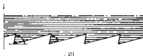
الف زاویه‌ی برش 8^\circ درجه زاویه‌ی دندانه‌ی 40^\circ تا 50^\circ درجه تیغه‌ی ارّه‌ی مناسب برای برش‌های طولی
