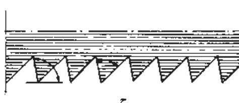
ج زاویه‌ی برش 10^\circ درجه زاویه‌ی دندانه‌ی 60^\circ درجه تیغه‌ی ارّه‌ی مناسب برای برش‌های درهم (طولی و عرضی)
