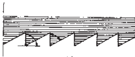
ب زاویه‌ی برش 9^\circ درجه زاویه‌ی دندانه‌ی 50^\circ تا 60^\circ درجه تیغه‌ی ارّه‌ی مناسب برای برش‌های عرضی و طولی
