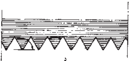
د زاویه‌ی برش 12^\circ درجه زاویه‌ی دندانه‌ی 60^\circ درجه تیغه‌ی ارّه‌ی مناسب برای برش‌های ظریف
