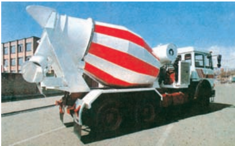
شکل ۴-۶- تراک میکسر (شامل مخزن مخلوط‌کننده، پمپ آب و قیف تخلیه)
