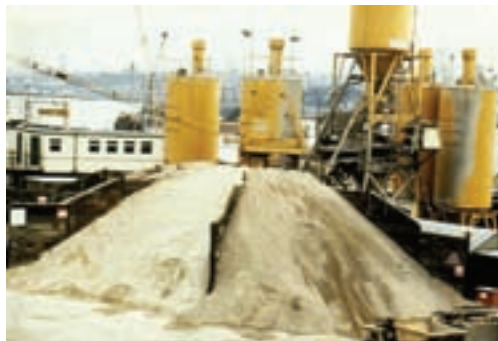
شکل ۱-۸ - استفاده از دیوار جداکننده در نگهداری سنگ‌دانه‌ها
