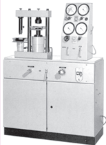
دستگاه ترکیبی تعیین مقاومت فشاری و خمشی نمونه های سیمانی براساس استاندارد BS 3892 و DIN 1164
