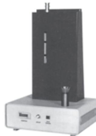
دستگاه الکترونیکی نفوذپذیری هوای Blaine که براساس استاندارد ASTM C204، BS 4550 و DIN 1164 کار می کند.
