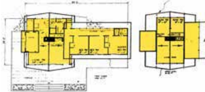
شکل ۶-۴۶- ترسیم پلان در ساختمان با سقف شیبدار
