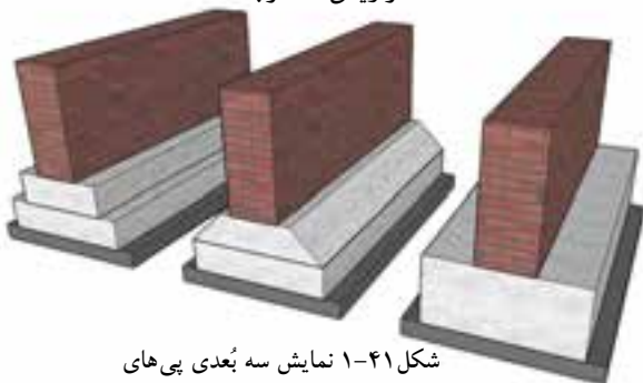
شکل ۱-۴۰ پی بتنی پلکانی با زاویه ۴۵ درجه
