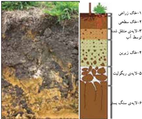
شکل ۱-۲ لایه‌های مختلف خاک با دانه‌بندی متفاوت
