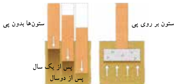
شکل ۳-۳۵ تاثیر بار بر روی پی و زمین
