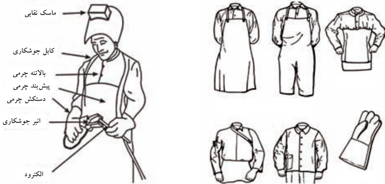
آماده شدن برای جوشکاری بالاسر
