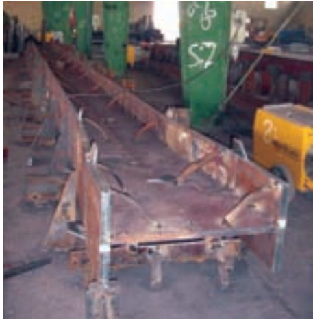
مونتاز تیوروق با تغییر مقطع در قالب
