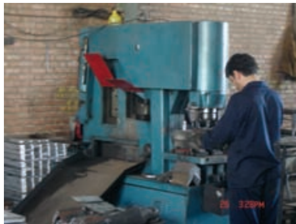
ب- دستگاه برش پروفیل‌های سبک (نبشی و ناودانی) و پانچ
