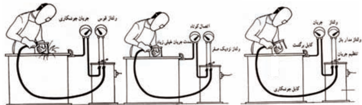
(الف) ولتاژ و آمپرژ در حالتی که مدار باز است (ب) ولتاژ و آمپرژ در حالت اتصال کوتاه (ج) ولتاژ و آمپرژ در حالت برقراری قوس
