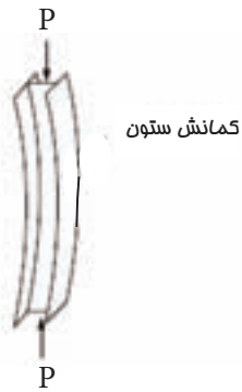
شکل ۴-۳- کمانش عضو فشاری
