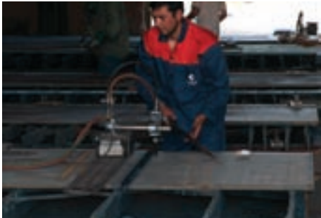
ب- عملیات برشکاری مرارتی ورق
