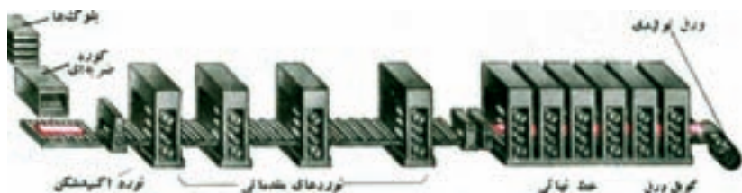
شکل ۱-۱۴- خط تولید نورد ورق
