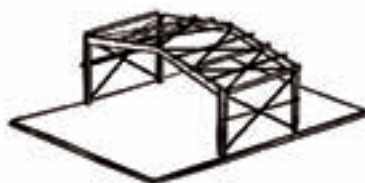
اجرای زیرسازی پوشش سقف (لاپه ریزی)
