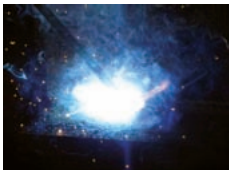
قوس الکتریکی در جوشکاری با الکتروود روکش‌دار
