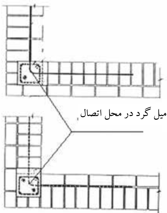
شکل ۱- ۵۰: رعایت اصول اتصال دو دیوار
