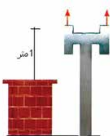
شکل ۱ - ۶۲: نصب صحیح لوله دودکش داخل اتاق
