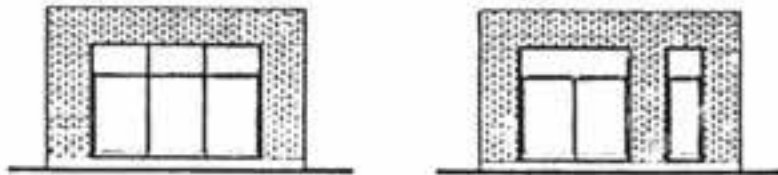
ج - بازشوهای نامطلوب به علت وسعت بیش از حد
